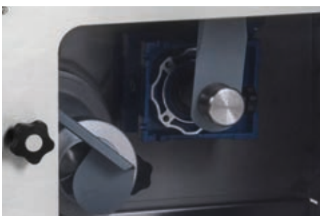
Focus boccole e meccanismo per l'uscita dell'impasto Focus nozzles and dough exit system
